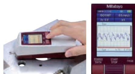
Známkování profilu ve skutečném čase během měření
